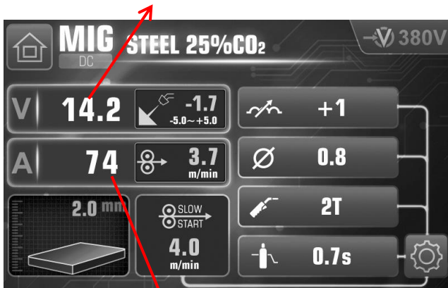
Corriente de soldadura real
