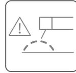
ANTISTICK: Evita que el electrodo se adhiera a la pieza mientras se esta soldando
