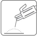
MMA (SMAW): Soldadura con electrodos revestidos
