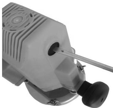
1. Retire y revise las escobillas de carbón con regularidad. Reemplace cuando la herramienta produzca chispas evidentes o desgaste hasta la marca límite.
