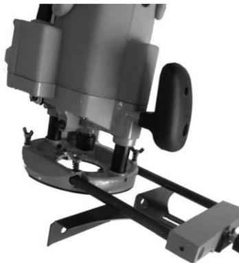
1. Instale la guía recta en el soporte de la guía con el perno de mariposa. Inserte el soporte de la guía en los orificios de la base de la herramienta y apriete el perno de mariposa. Para ajustar la distancia entre la broca y la guía recta, afloje el perno de mariposa (B) y gire el tornillo de ajuste fino. A la distancia deseada, apriete el perno de mariposa para asegurar la guía recta en su lugar.
