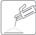
MMA (SMAW): Soldadura con electrodos revestidos
