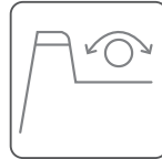
HOT START: Para facilitar el cebado del arco
