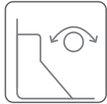
ARC FORCE: Evita que se apague el arco eléctrico durante la soldadura
