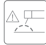
ANTISTIC: Evita que el electrodo se adhiera a la pieza mientras se esta soldando
